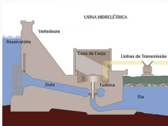
Figura 1: Funcionamento de uma Usina Hidrelétrica
