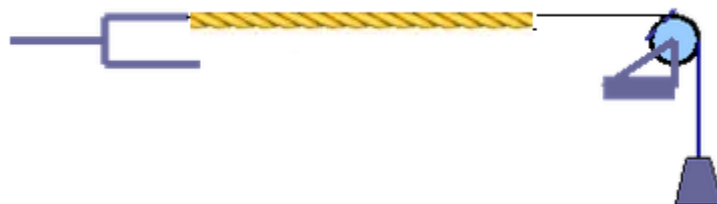
Figura 24: Diapasão ligado a corda com extremidade quase livre Crédito:[Geocities,2001]
