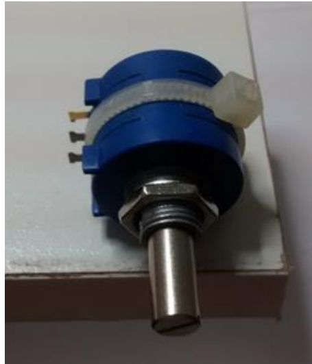
Fig. 9b: Montagem do potenciômetro multivolta.
