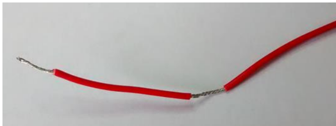
Fig. 11: fio vermelho descascado.
