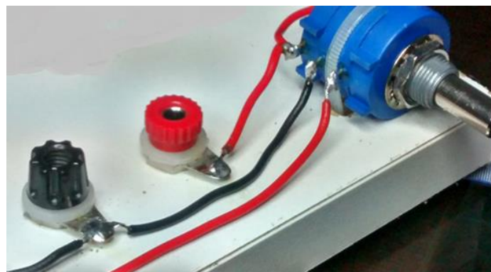
Fig. 13b: Soldas nos bornes inferiores.
