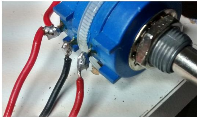
Fig. 13a: Soldas no potenciômetro
