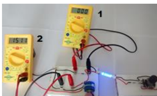
Figura 5.11: Sequência de imagens em que os voltímetros 1 e 2 apresentam, respectivamente, fotocorrente zero e potencial de frenagem V_f = 1511 mV.
