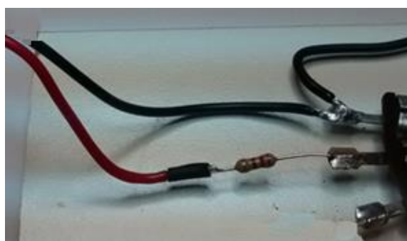
Fig 2b: fio preto e vermelho soldados no potenciômetro
