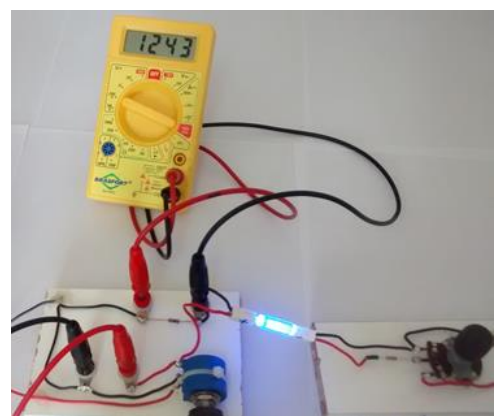
Figura 5.8b: LED azul iluminando LED verde. Com fotocorrente de 1,243 \mu\text{A}
