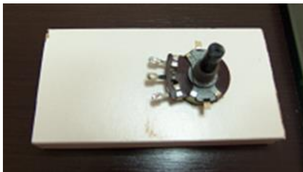
Fig.1b: Base de madeira e potenciômetro fixado.
