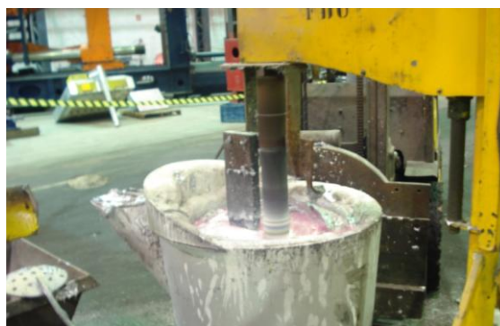
Figura 4.3 - Processo de desgaseificação do metal (Fonte Cofaz).
