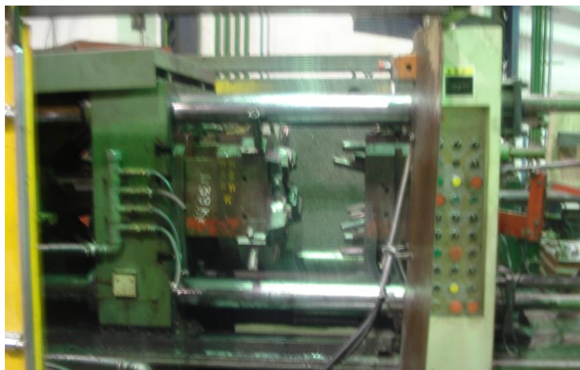
Figura 4.4 - Máquina injetora de câmara fria utilizada durante o processo de injeção sob pressão (Fonte Cofaz).
