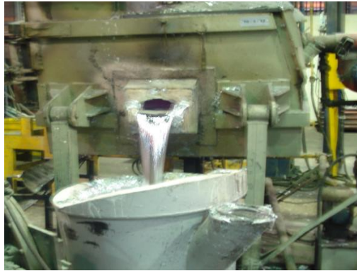
Figura 4.2 - Forno de fusão a gás e panela de vazamento (Fonte Cofaz).
