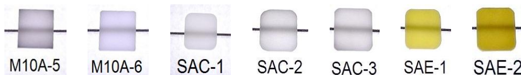
FIGURA 6.27 – Imagem de amostras com superfícies polidas de 1 mm de espessura de compósitos translúcidos obtidos por infiltração de vidro em pré-forma de alumina para caracterização óptica.
