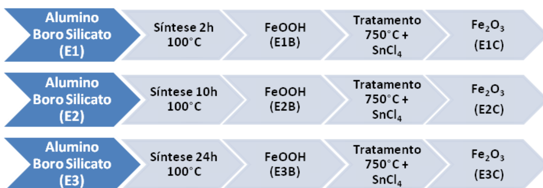
Figura 12. Resumo das amostras sintetizadas com redução de cloro para os testes de incorporação de \text{SnO}_2 .
