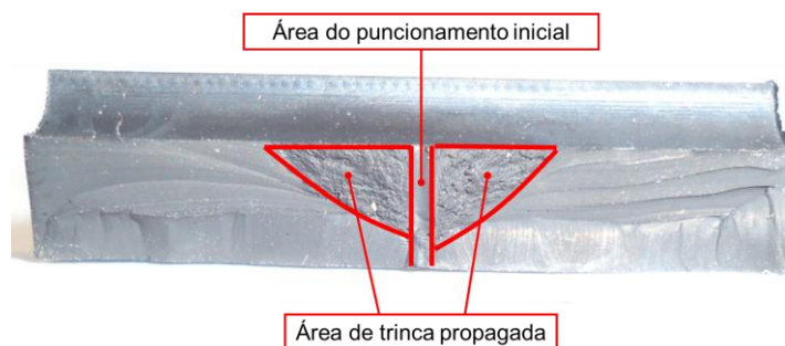
Figura 53 – Seção transversal da trinca do corpo de prova da formulação NRCB com comprimento de trinca de 9 mm.
