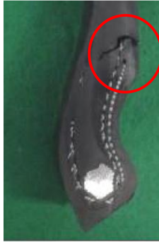
Figura 5 - Falha por fadiga mecânica na extremidade da carcaça metálica.
