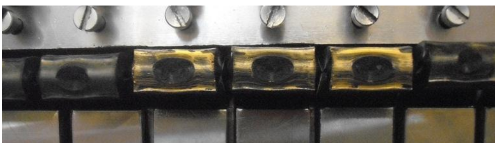
Figura 41 - Vista superior dos corpos de prova de NRCB em máxima deformação.
