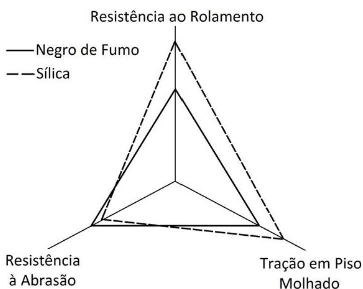
FIGURA 16 – Triângulo mágico da diferença no comportamento de um composto com sílica e negro de fumo.
