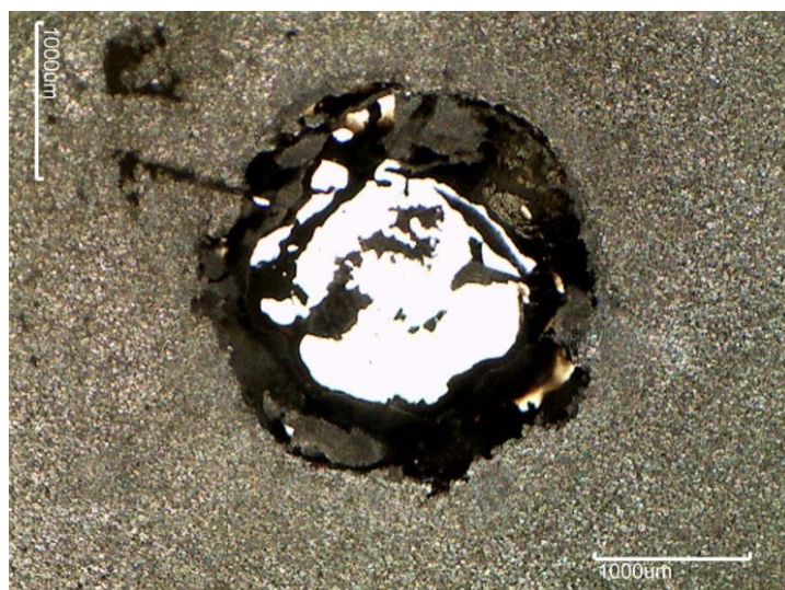
Figura 41: Orifício sobre os eletrodos de IPMC para a passagem do feixe de raios-X.
