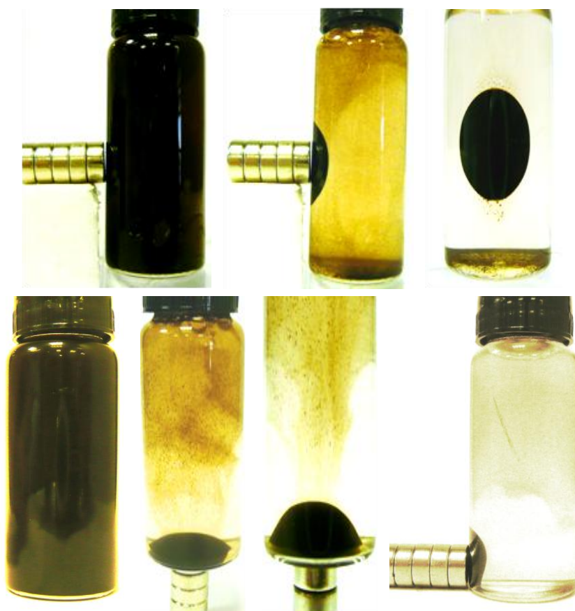
Fig. 3.3- Ferrofluido formado por partículas magnéticas diluídas em água. O gradiente de campo magnético gerado pela aproximação do ímã faz com que as nano/micro partículas magnéticas se concentrem na região próxima ao pólo magnético do ímã, separando-as do meio. Imagens obtidas no laboratório 508-3-UFABC.
