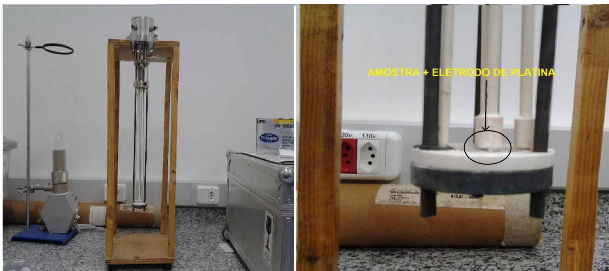
Figura 18- Estrutura do impedancímetro onde as amostras são colocadas junto aos eletrodos de platina.
