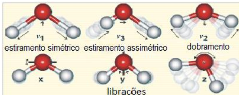
Figura 6 – Tipos de vibração: estiramento simétrico ( \nu_1 ), estiramento assimétrico ( \nu_3 ) e scissoring ( \nu_2 ) e librações nos eixos x, y e z [26]. Na figura: em vermelho, o átomo de oxigênio; e em branco, o átomo de hidrogênio.
