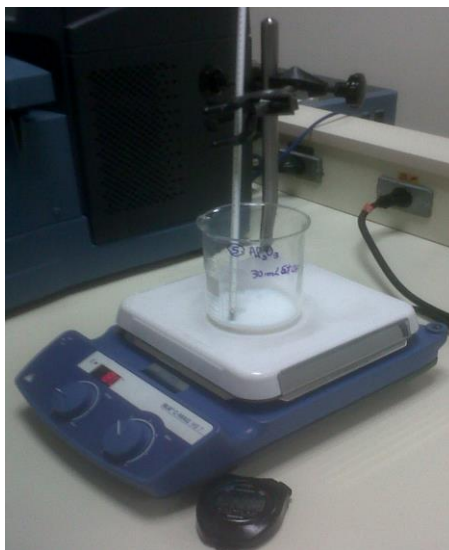
Figura 3.5 – Foto da chapa de aquecimento com agitação e o aparato utilizado para a mistura da suspensão dos aditivos em óleo básico.
