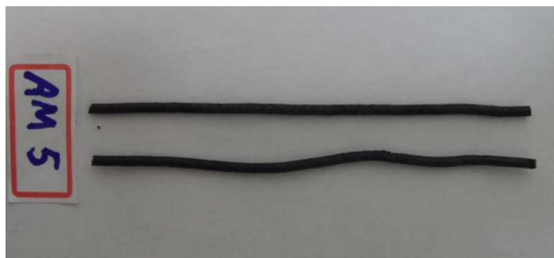
FIGURA 31 – Amostra 5 após processo de extrusão. (forma de filamentos)
