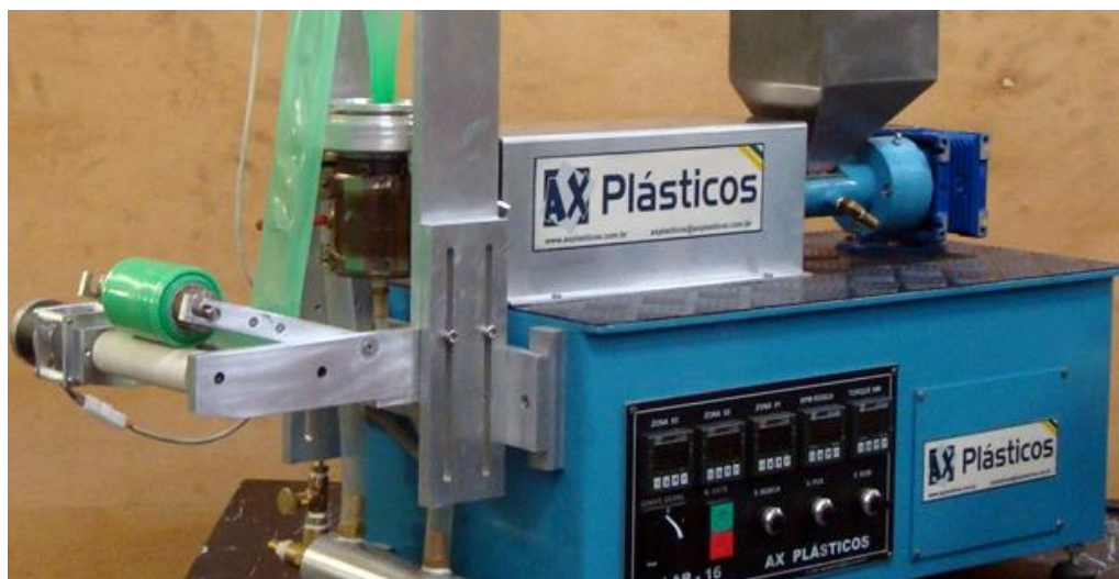
Figura 39 - Extrusora para filme tubular
