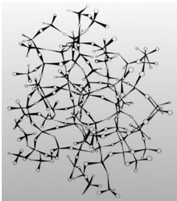
Figura 16 - Arranjo esquemático de uma estrutura de sílica amorfa. Os círculos simbolizam os átomos de oxigênio, nos centros dos tetraedros estão os átomos de silício [80]
