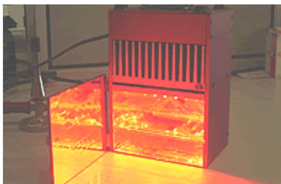
Figura 38. Fonte de luz utilizada (LED com emissão em 660 nm).
