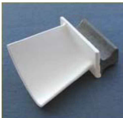
FIGURA 39 – Exemplo de revestimento de silicato em imagem de componente de nitreto de silício, através da técnica de recobrimento slurry (SÁNCHEZ, 2009).
