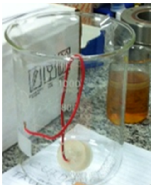
FIGURA 38 – Detalhe do fio soldado na amostra embutida tipo P1 de recobrimento polimérico.
