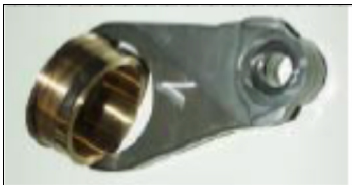
FIGURA 10 – Bronzinas de biela em formato de bucha, mostrando na região escura a queima do lubrificante (KOCH, 2009).
