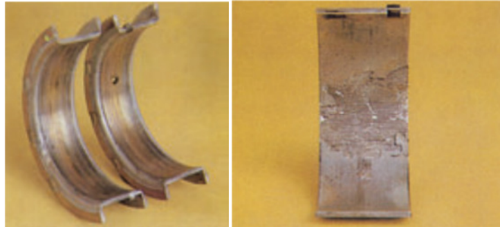
FIGURA 22 – Bronzinas com aspectos de fadiga generalizada (Manual de falhas MAHLE, 2013).
