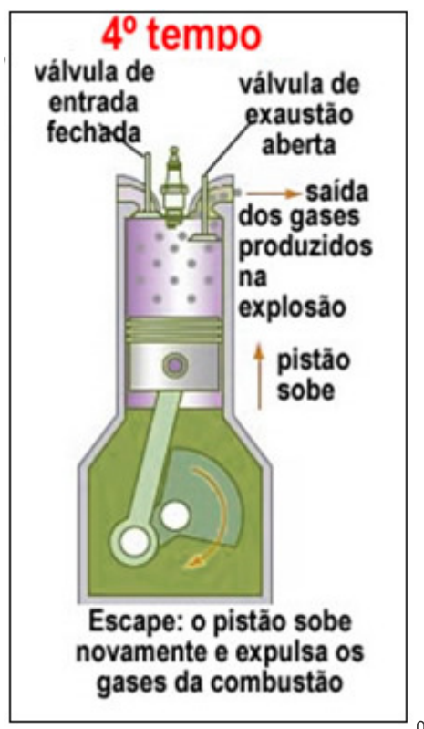
FIGURA 6 - 4º TEMPO: escape dos gases eliminados durante a combustão (BRUNETTI, 2012).
