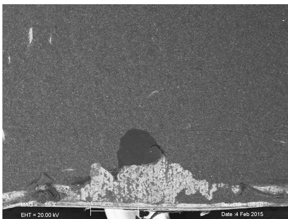
FIGURA 64 – Detalhe de microscopia eletrônica de varredura das amostras de recobrimento polimérico tipo P1, onde houve arrancamento da superfície, escala de um mm.
