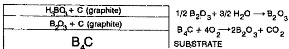
FIGURA 36 – Desenho esquemático do recobrimento de caráter cerâmico de óxido de boro sobre fragmentos de bronzinas (ERDEMIR et al, 1996).
