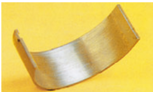
FIGURA 11 – Linhas de usinagem de uma Bronzina em perfeitas condições, após o uso (Manual de falhas MAHLE, 2013).
