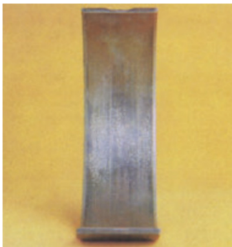
FIGURA 19 - Linhas de bom funcionamento hidro dinâmico de uma bronzina após uso. Coloração escura mostra a queima do óleo lubrificante (Manual de falhas MAHLE, 2013).
