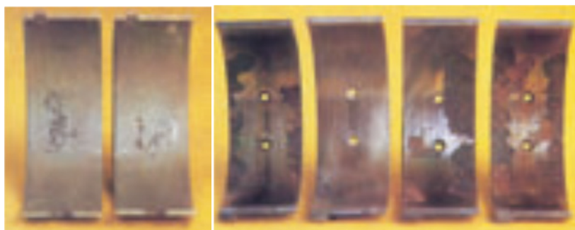
FIGURA 20 – Imagens de bronzinas com corrosão nas superfícies de (Manual de falhas MAHLE, 2013).
