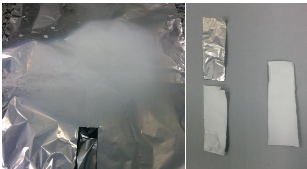
Figura 8: Imagens fotográficas das mantas. Potencial elétrico aplicado: 20 kV. Distância de trabalho: 10 cm.
