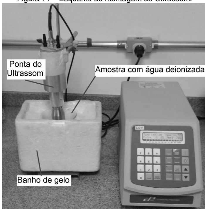
Figura 11 – Esquema de montagem do Ultrassom.
