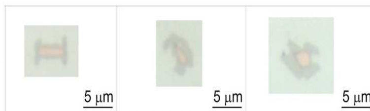
Figura 16. Precipitados envolvidos por camadas. Imagens obtidas por microscópio óptico. (Michelic, et al., 2015).
