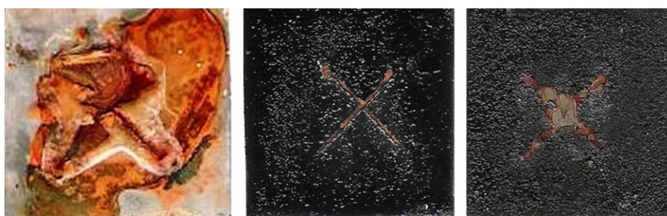
Figura 8 - Imagens das amostras de aço (2 cm x 2 cm) recobertas por uma camada de revestimento epóxi sendo, epóxi comercial sem modificações (a esq), epóxi contendo 5% de PANI sintetizada via química (meio) e epóxi contendo 10% de PANI sintetizada via química (dir), após 80h de imersão em solução contendo 3,5% de NaCl 39 .
