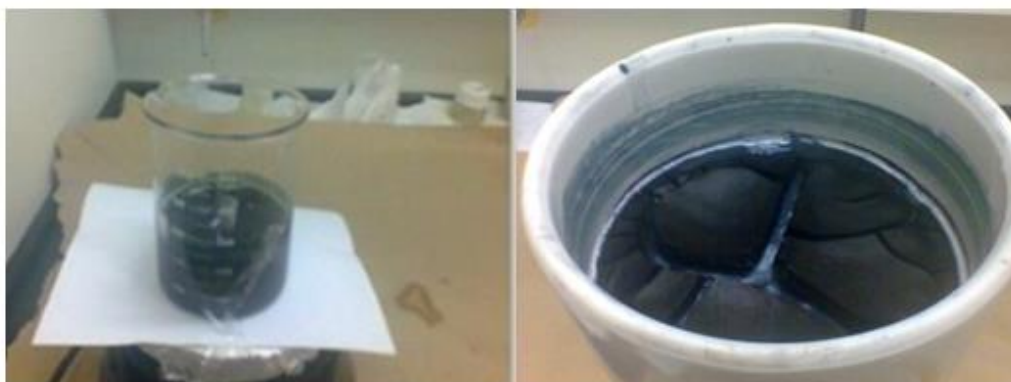
Figura 14 - Imagens da síntese da PANI, a esquerda, e da filtragem final, a direita.
