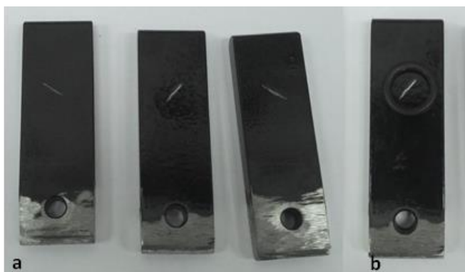
Figura 18 - Amostras dos ensaios eletroquímicos de corrosão após riscamento para exposição do substrato. (a) amostras riscadas, (b) risco contido na área de exposição pelo anel de vedação da célula de corrosão.
