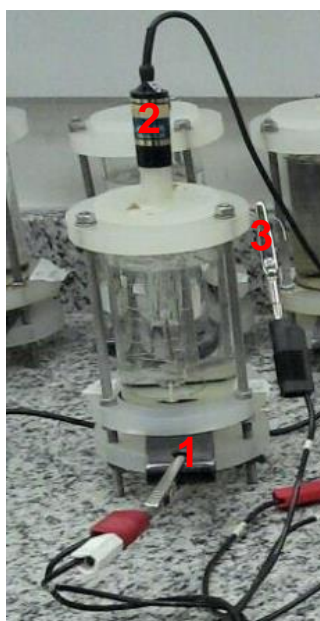
Figura 19 - Célula eletroquímica utilizada nos ensaios de corrosão. (1) Eletrodo de trabalho, a amostra. (2) Eletrodo de referencia (Ag/AgCl). (3) Contra eletrodo de Platina.
