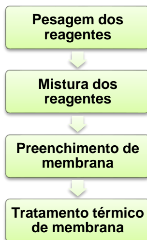
Figura 13 – Sequência das etapas que compreendem a rota de síntese das amostras.
