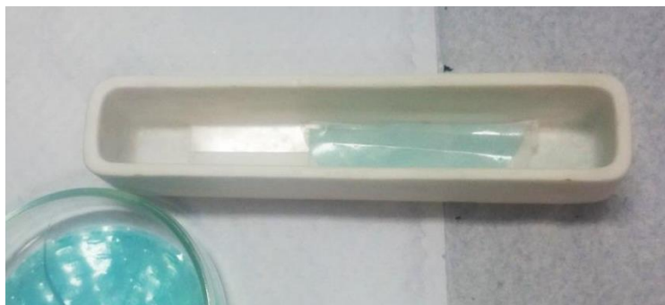
Figura 16 – Fotografia do pedaço de membrana de policarbonato preenchida sobre substratos de quartzo dentro de um cadinho de alumina.
