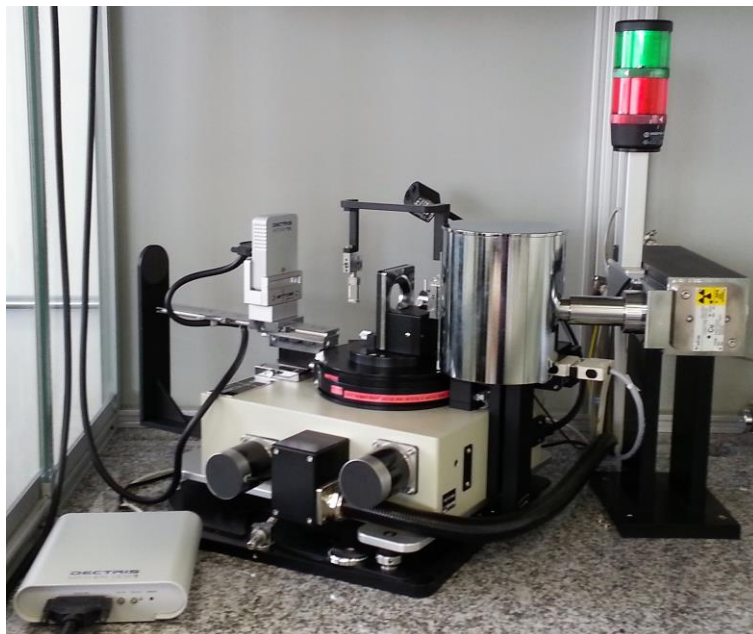
Figura 38 – Difratorômetro de raios X por policristais com fonte de \text{CuK}\alpha 1 .
