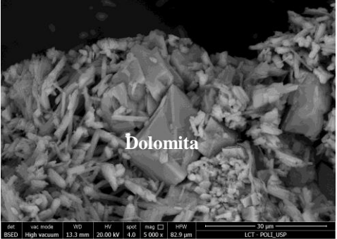
Figura 138 – Imagens de MEV de pastas de gesso endurecidas produzidas a partir dos gessos comerciais (à esquerda) e diagramas EDS (à direita): a) gesso A, b) gesso B, c) gesso C e d) gesso D.
