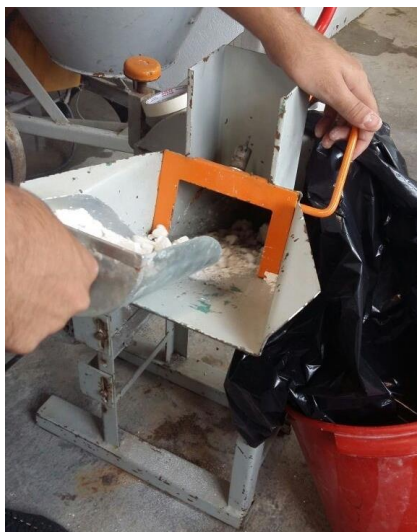
Figura 25 – Moagem das placas de gesso hidratado em moinho de martelos.
