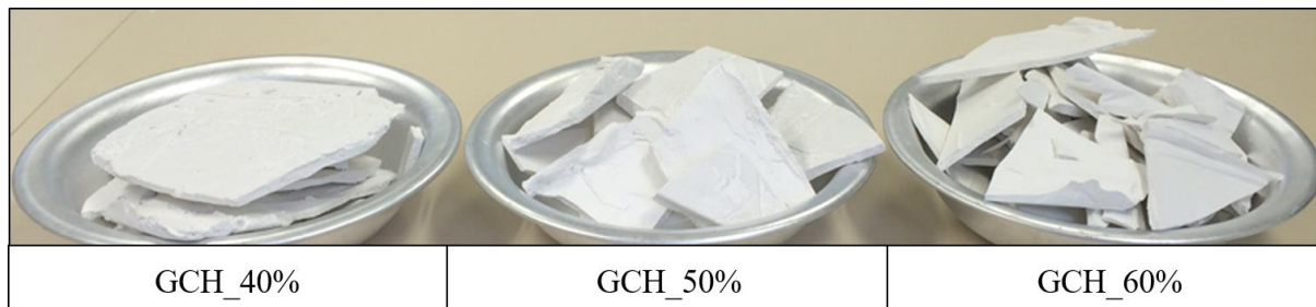
Figura 24 – Placas de gesso hidratado secas e quebradas manualmente.
