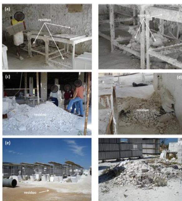
Figura 7 – Geração de resíduos durante processo de fabricação artesanal de componentes de gesso: área de conformação (a e b), área interna da fábrica (c e d) e área externa da fábrica (e e f).
