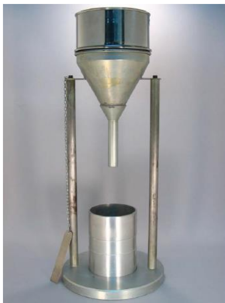
Figura 144– Aparelho para determinação da densidade de massa aparente.
