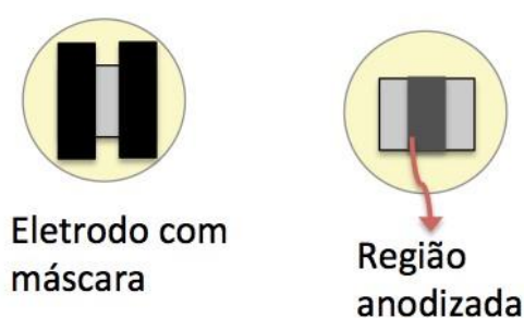
Figura 13 Esquema de amostra anodizada para análise em confocal.
