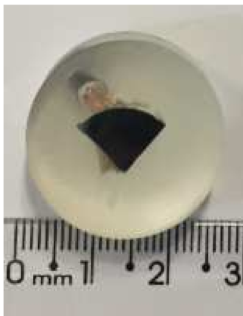
Figura 13: Aço inoxidável austenítico ISO 5832-1 embutido em resina epóxi revestido pela condição PPy-0,5 M.
