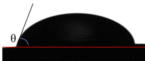
Figura 21. Fotografia da medida de ângulo de contato.
