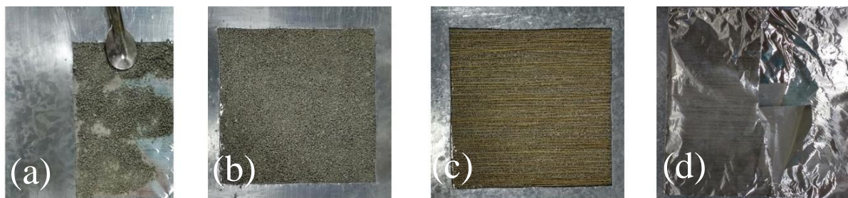
Figura 18. Etapas da moldagem dos compósitos: (a) distribuição do PPpc moído na placa de alumínio, (b) placa de alumínio com o PPpc moído, (c) sobreposição do molde de zinco com as FC orientadas unidirecionalmente e (d) fechamento do conjunto com a placa metálica.
