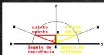
Figura 11: Estão representados os triângulos utilizados na relação entre os ângulos de incidência e reflexão.
