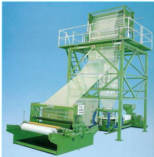
Figura 6.4 Ilustração do processo de extrusão-sopro de filmes plásticos. Fonte: Harada (2016)
