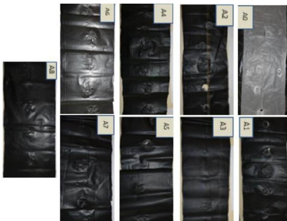
Figura 7.9 Ilustração dos filmes "rompidos" após os testes de impacto de queda livre para a blenda A0 e compósitos A1 a A8.
