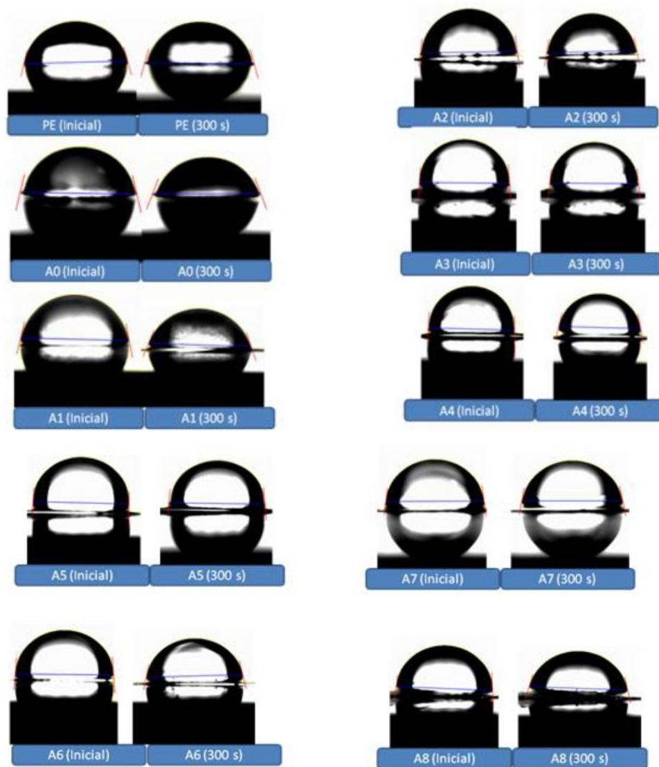
Figura 7.17 Ilustração das imagens do ângulo de contato do polietileno, da blenda e dos compósitos.
