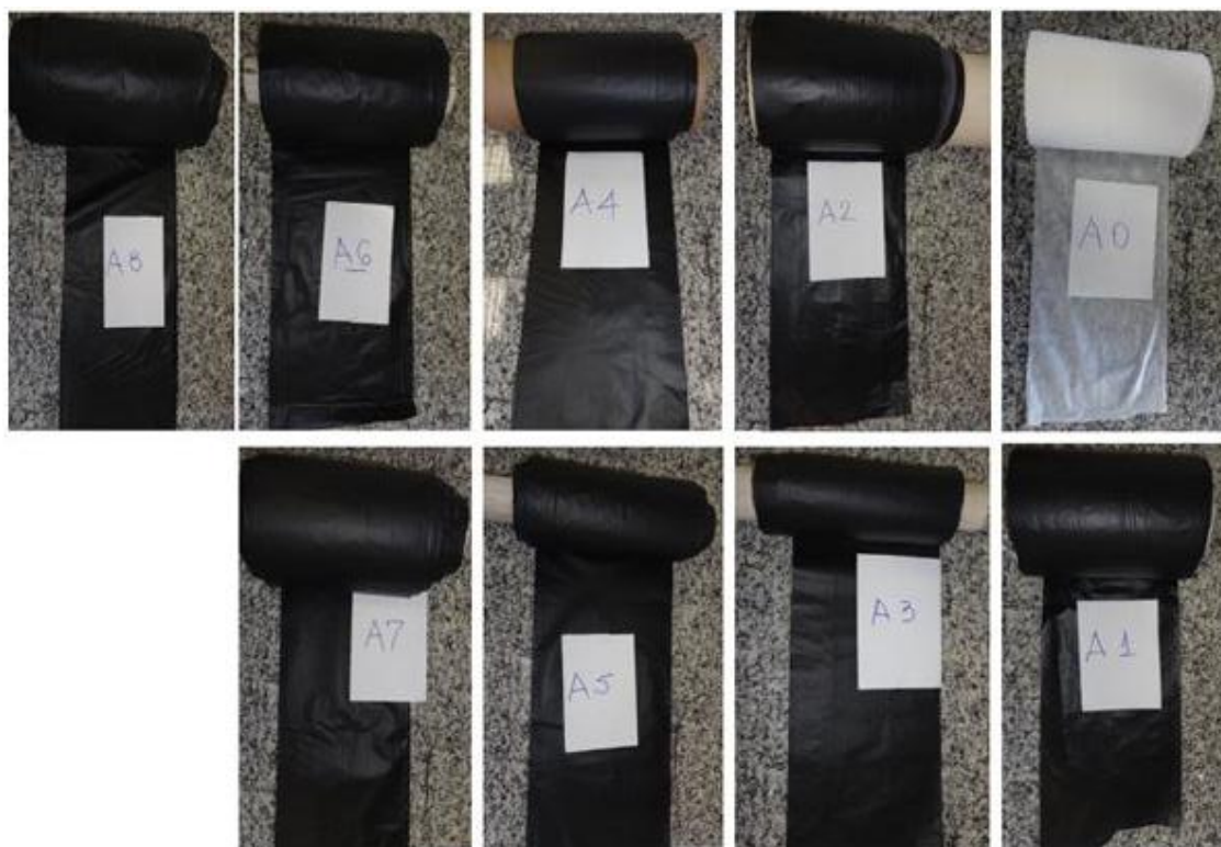
Figura 7.2 Ilustração dos filmes produzidos da blenda A0 e dos compósitos, de A1 até A8. Fonte: Harada (2016).
