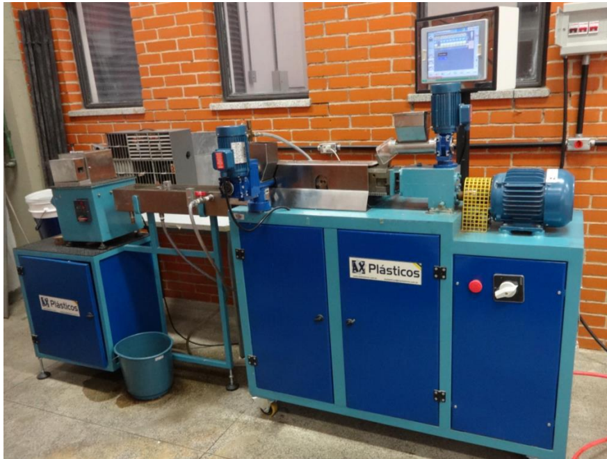
Figura 6.1. Ilustração da extrusora dupla rosca utilizada para a preparação das amostras. Fonte: do próprio autor, Laboratório CTR, IPEN (2017)
