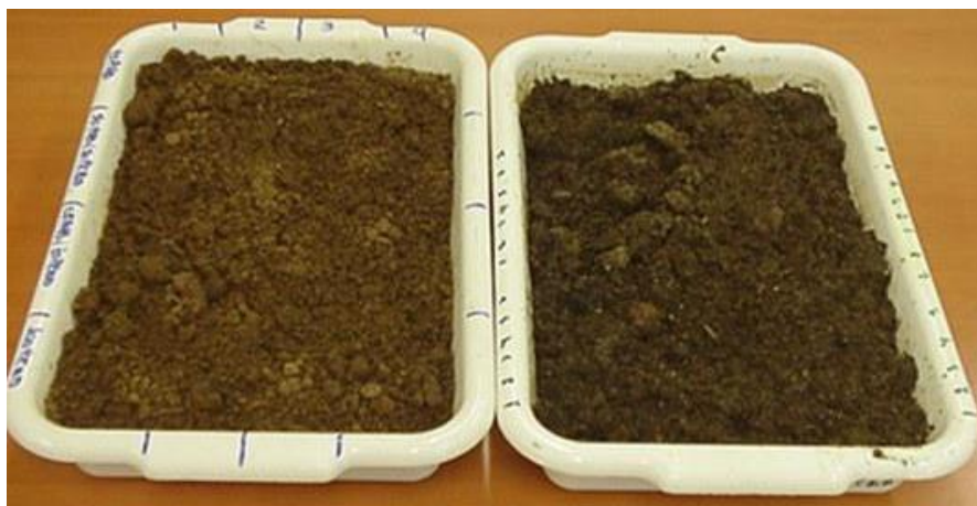
Figura 6.6 Ilustração do solo simulado condicionado em bandejas plásticas (biodegradação). Fonte: Rezende (2007).
