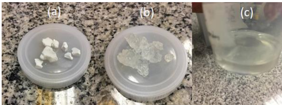
Figura 46. Os três aspectos das dispersões de sílica hidrofílica Aerosil 200 com concentração de 10% em volume de partículas resultantes da variação de condições de tempo e amplitude de sonicação, (a) sólido, (b) gel e (c) líquido.
