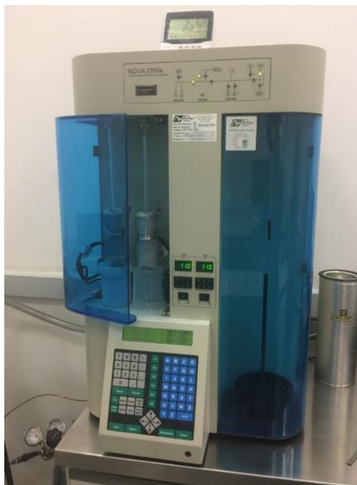
Figura 30. Equipamento da Quantachrome utilizado para a análise da área superficial das partículas.
