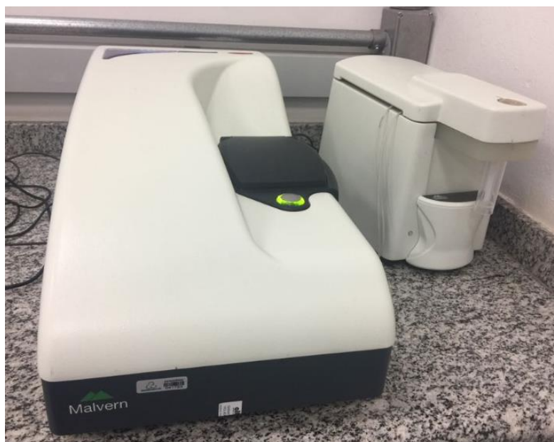
Figura 31. Medidor de Potencial Zeta Malvern Zetasizer NanoZS, utilizado para a análise de potencial zeta de partículas em dispersões.
