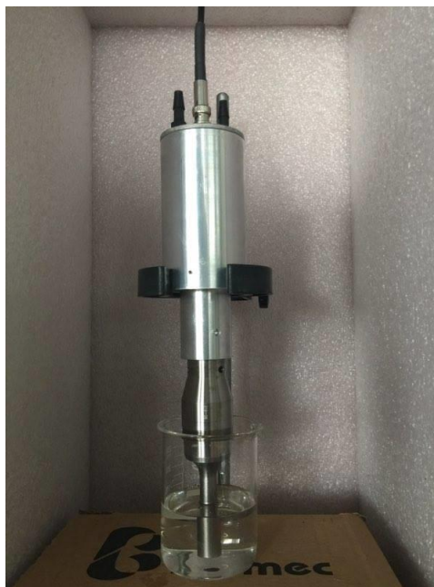
Figura 34. Sonicador Vibracell VCX 750 utilizado para preparar as dispersões.
