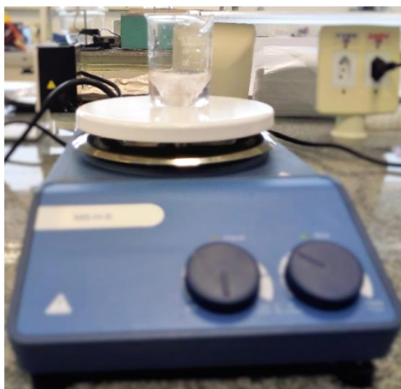
Figura 8. Aparato experimental para a síntese do cátion-radical a partir da \text{PHA}^+ .
