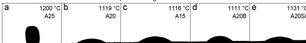
Figura 11 – Imagens do microscópio de aquecimento comparando o vidro A25 na temperatura de 1200 °C com os demais vidros na última temperatura registrada.
