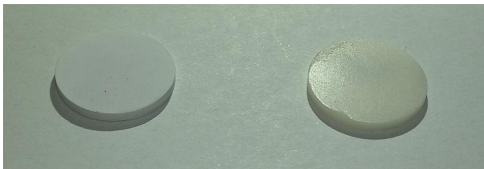
Figura 17 – Imagem mostrando a comparação entre um disco de alumina poroso, pré-forma (esquerda), e um disco infiltrado pelo vidro A20 (direita), ambos com 10 mm de diâmetro.
