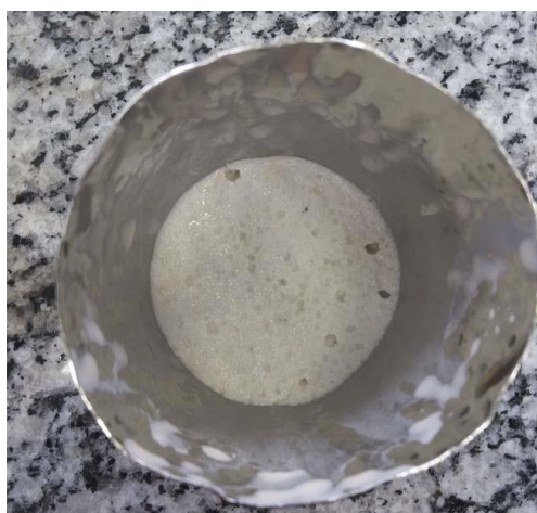
Figura 6 – Cadinho com o vidro A5 endurecido após tentativa de fusão
