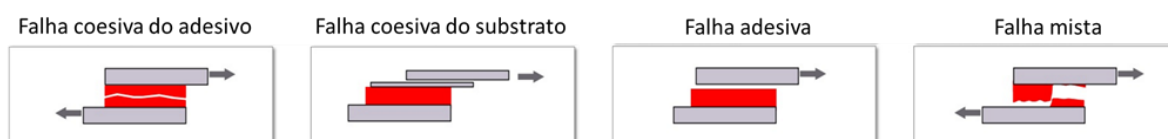
Figura 21: Diferentes tipos de mecanismos de falha que podem ocorrer em junções adesivas.
