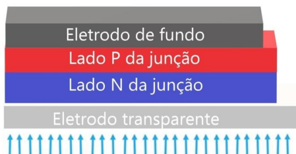
Figura 3 - Empilhamento exemplificativo de um dispositivo fotovoltaico de calcogeneto.
