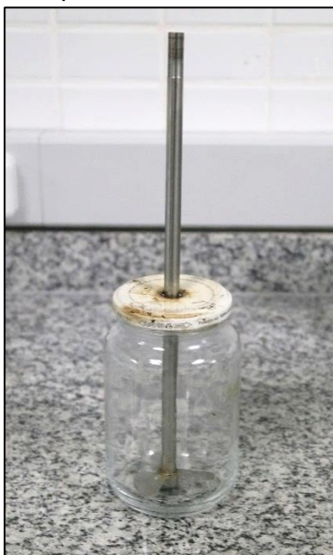
Figura 11 – Foto do reator utilizado para a microencapsulação do microrganismo B. amyloliquefaciens pelo método de emulsificação.
